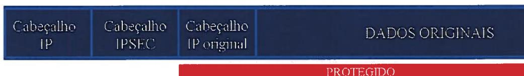
Figura 24 - Modo de Operação do protocolo Ipsec
