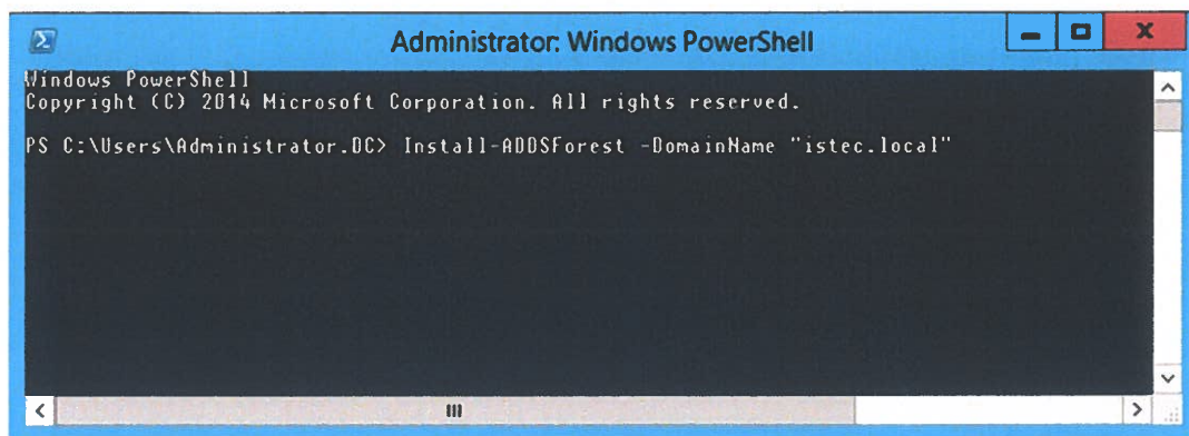
Figura 19 – Promoção a Domain Controller , criação de um domínio e de uma floresta.
